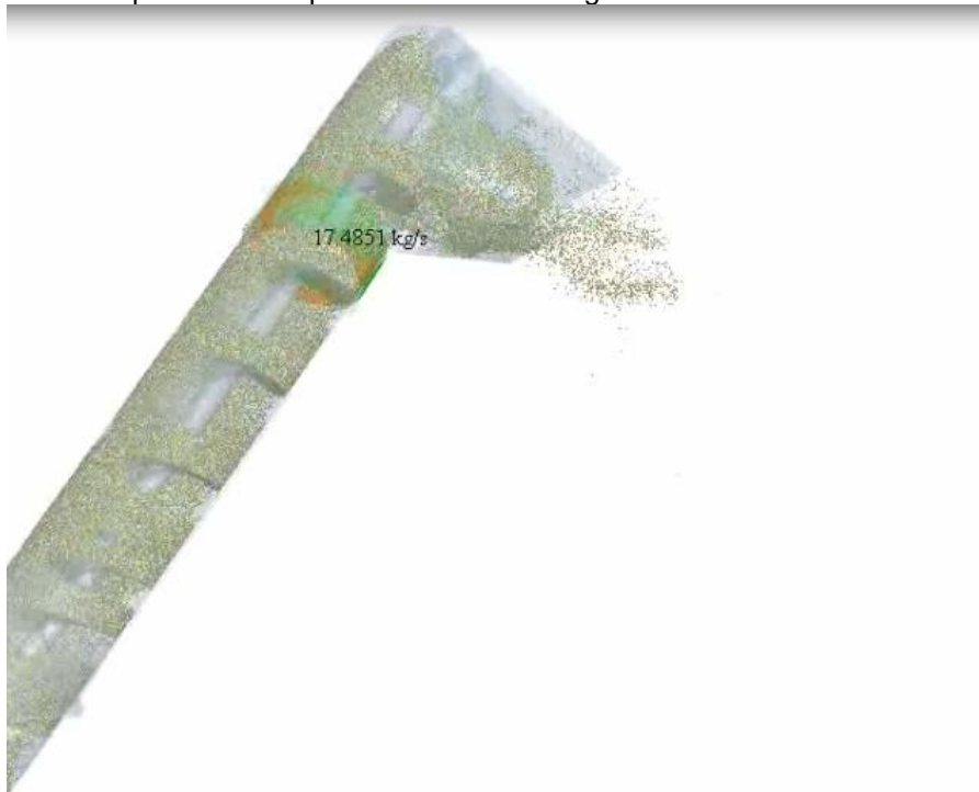
Figura 31 – Imagem representando o segundo sensor de vazão mássica, com sessão de 250mm de raio, posicionado próximo ao topo do tubo de descarga
