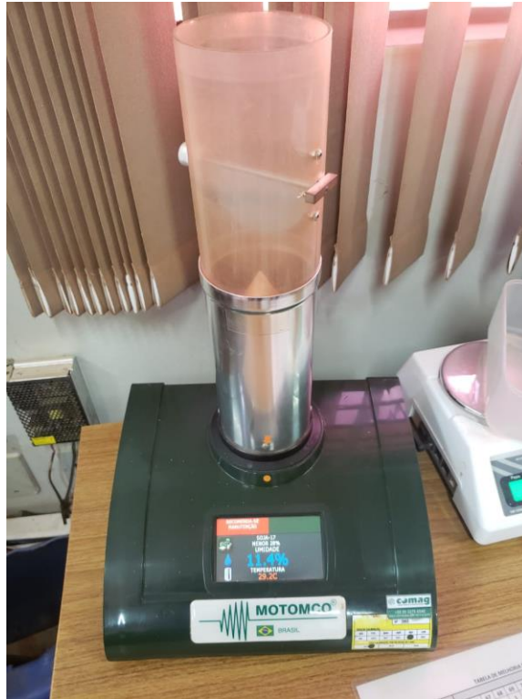
Figura 22 – Imagem do medidor Motomco 99FBI realizando a medição da amostra de grãos de soja no dia 23 de setembro de 2020, resultando em 11,4 % de teor de umidade
