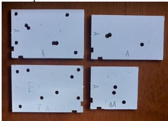
Desta forma, consegue-se manter uma repetitividade e igualdade entre as peças, além de facilitar e agilizar a fabricação das mesmas, garantindo uma posição e montagem quase que perfeita do conjunto final. Um detalhe que se pode observar, são os entalhes feitos em dois lados de cada gabarito, para utilizar como referência para encosto sempre do mesmo lado, assim se o bloco tiver alguma pequena variação de tamanho, dois lados, no mínimo, sempre terão faces paralelas na montagem.
