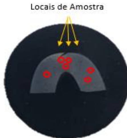
Figura 20 – Regiões da amostra para medição de microdureza Vickers
