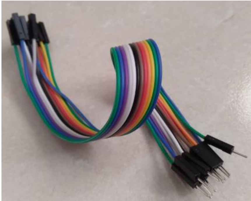
Figura 14 – Cabos Wire Jumper Fêmea-macho Protoboard Arduino
