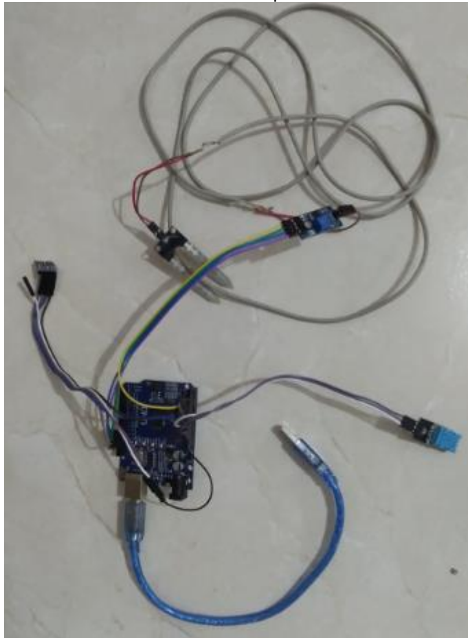
Figura 28 – Imagem da união dos três sensores com a placa Arduino
