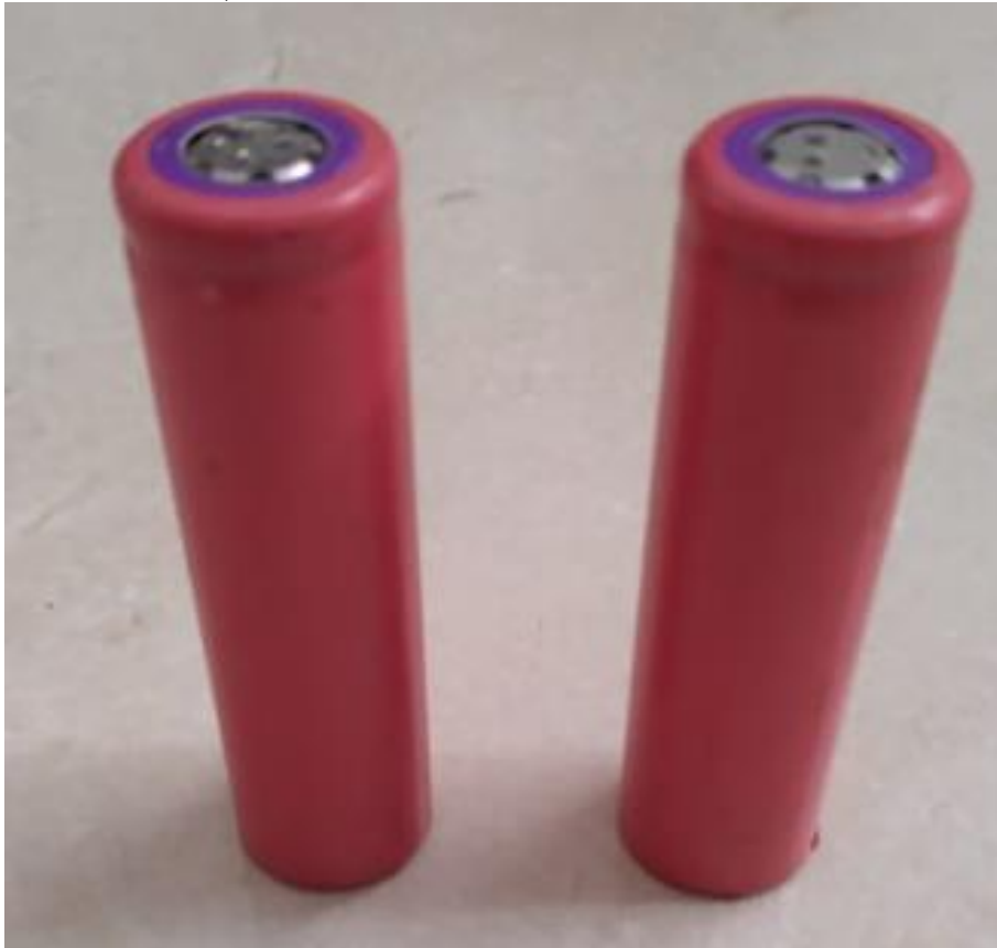
Figura 17 – Baterias de lítio 3,7V 6800mah
