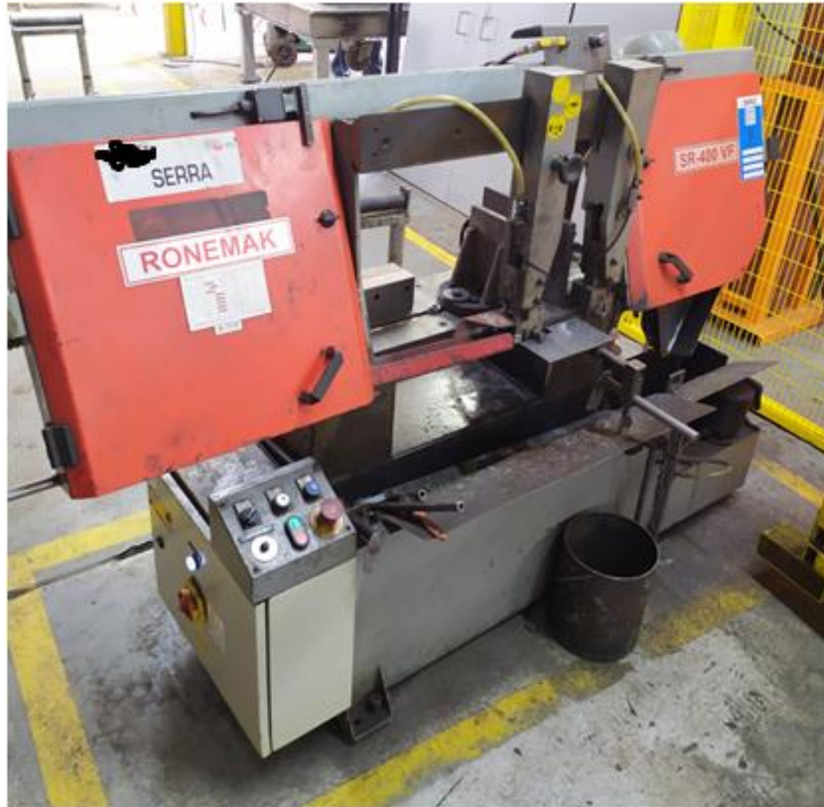
Figura 34 – Corte de tubos com serra fita
