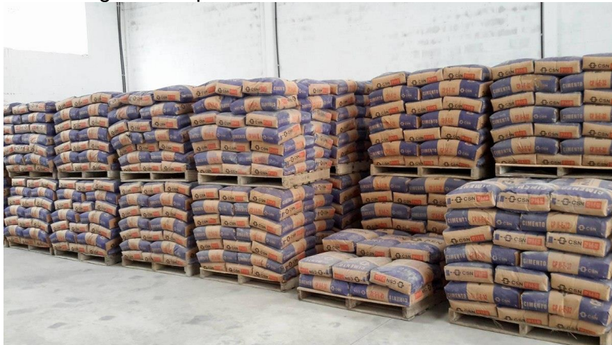
Figura 7 – Armazenagem com paletes
