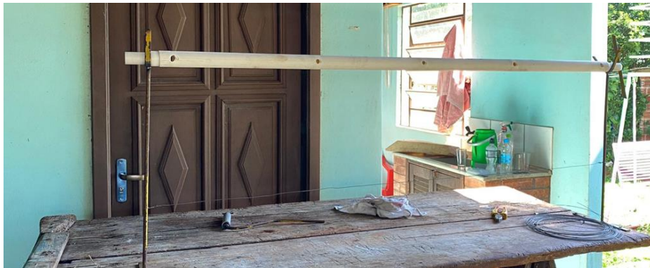
Figura 25 – Dispositivo para posicionamento e laminação da fibra de vidro nos tubos de PVC
