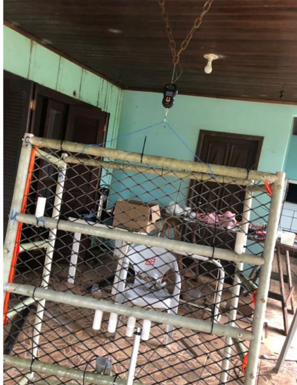
Figura 34 – Pesagem da caçamba
