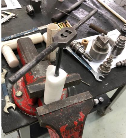
Figura 30 – Processo de fabricação de roscas internas com utilização de macho
