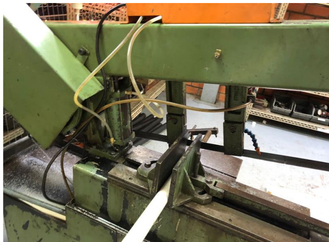
Figura 28 – Corte de insertos de poliacetal com auxílio de serra
