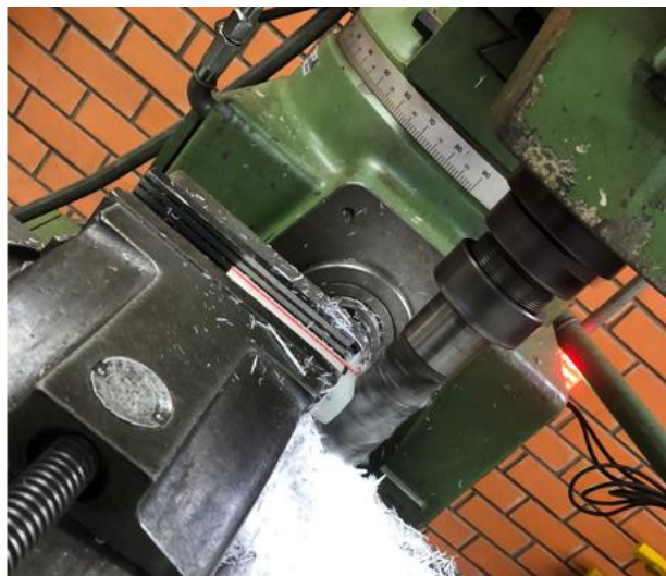
Figura 31 – Fresamento dos insertos para encaixe nos tubos de PVC
