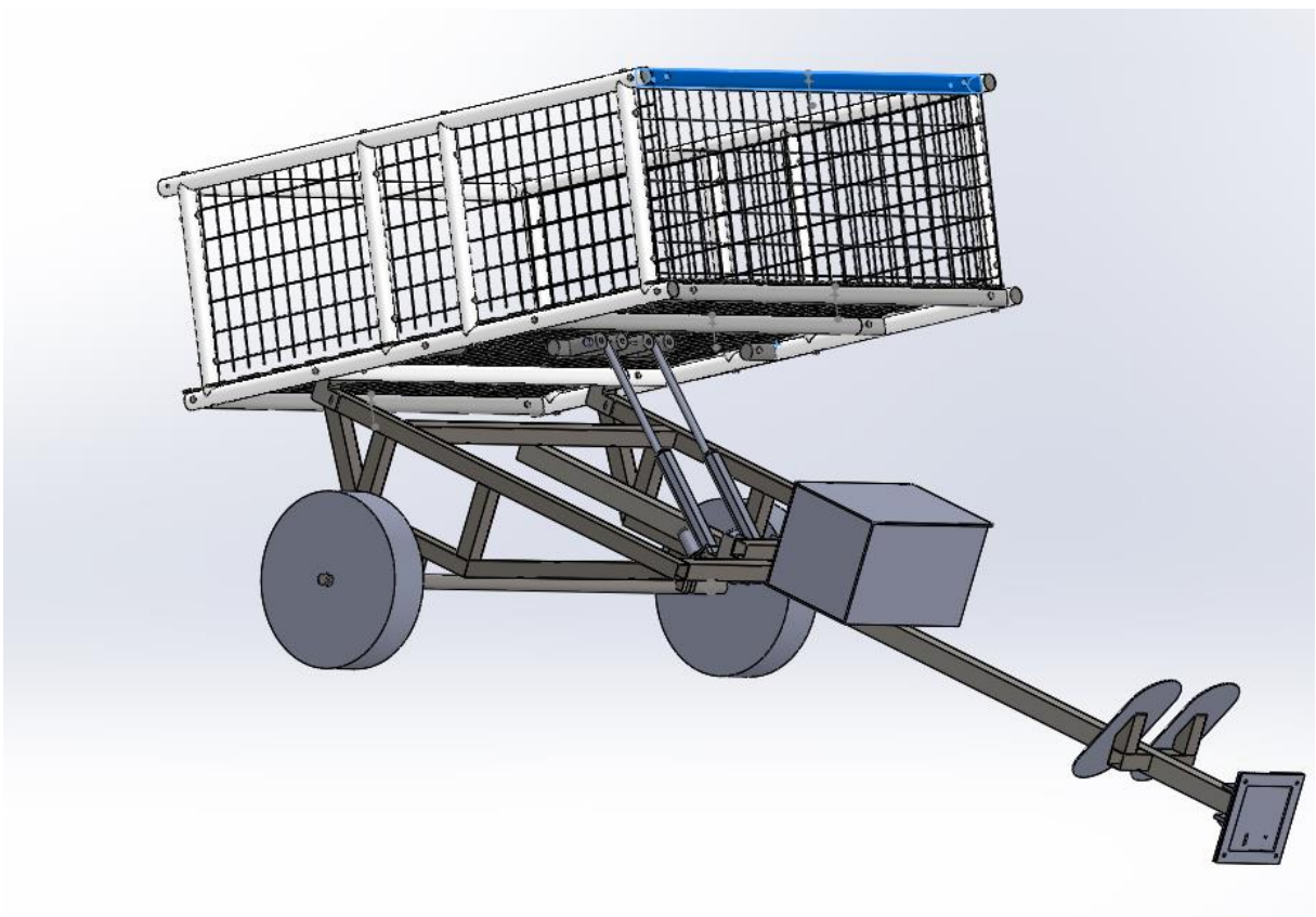
Figura 17 – Perspectiva isométrica da carreta basculante com os atuadores em posição “levantados”
