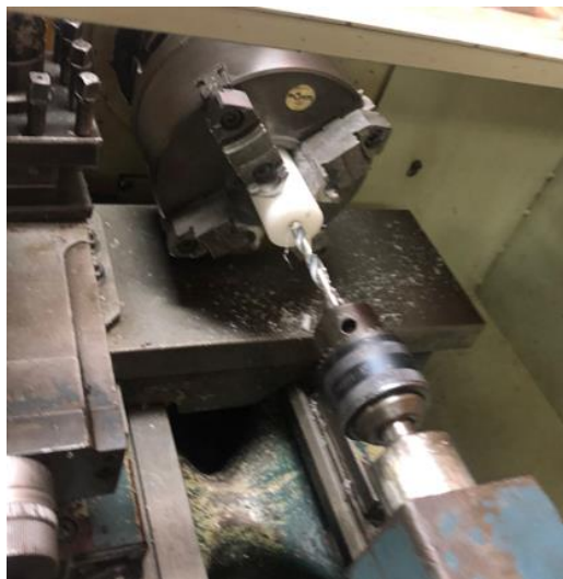
Figura 29 – Processo de furação central nos insertos de poliacetal
