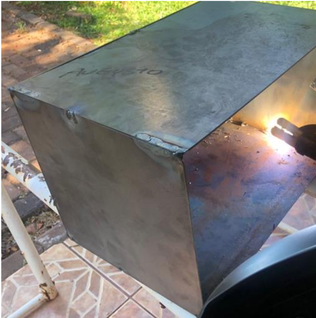
Figura 38 – Soldagem caixa de bateria e assento
