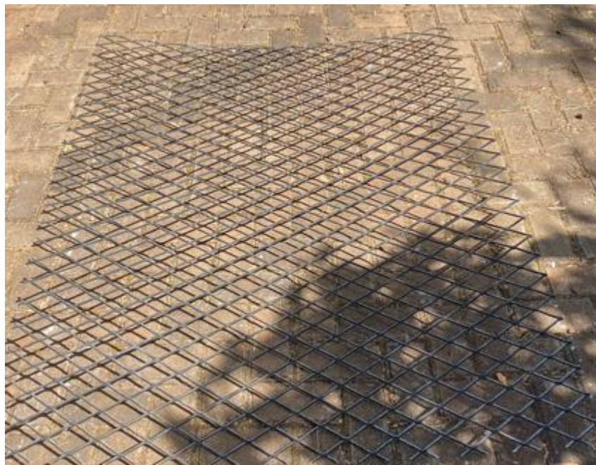
Figura 33 – Chapa expandida cortada com auxílio de guilhotina
