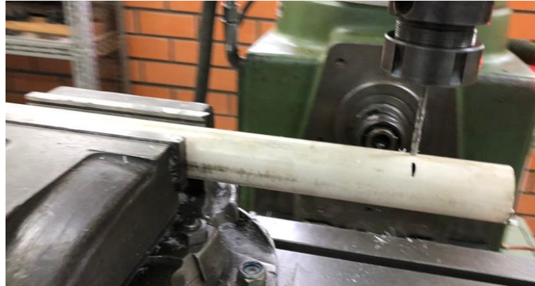
Figura 24 – Furação tubos PVC com auxílio de fresadora
