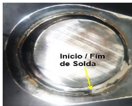
Figura 17: Especificação do início e fim de solda
