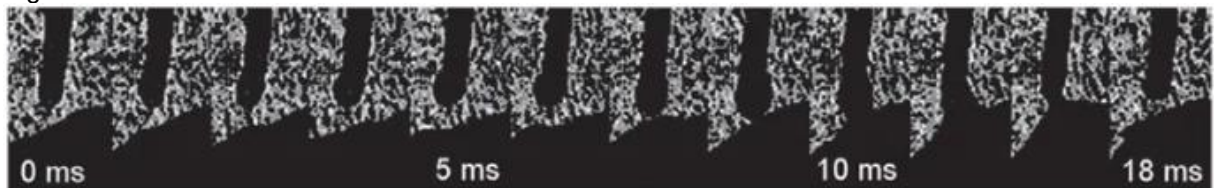
Figura 2.9 – Modo de Transferência Curto-Circuito
