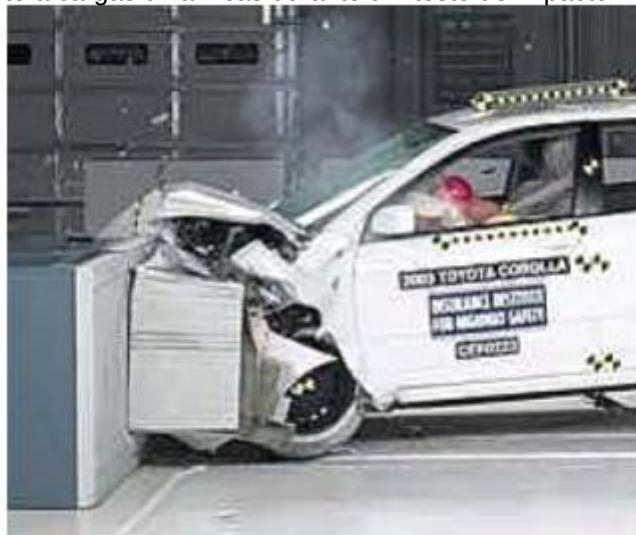
Figura 2 – Veículo exposto a cargas dinâmicas durante um teste de impacto
