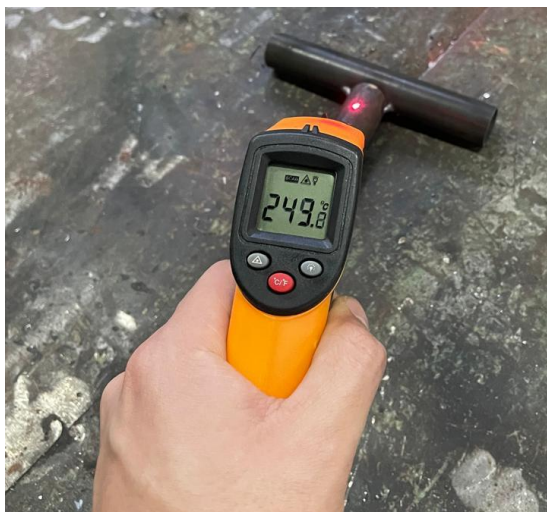
Figura 11 – Procedimento utilizado para monitorar o controle de temperatura de pré-aquecimento das amostras
